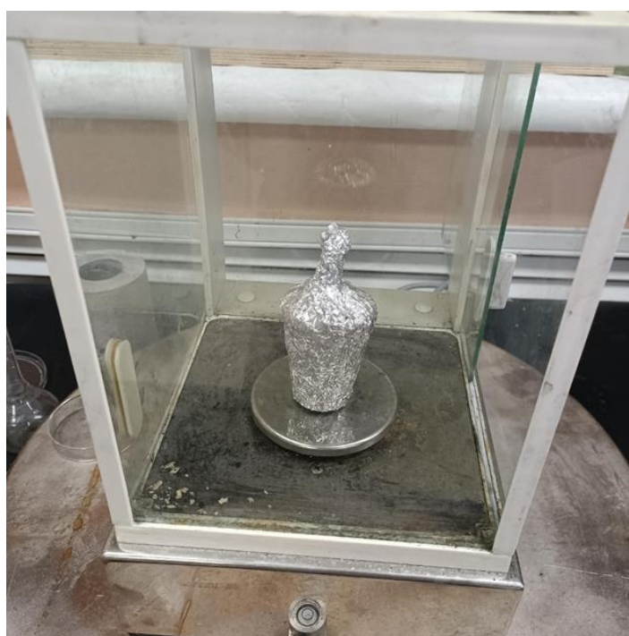
Рисунок 5 – Фото тигля для проведения пиролиза
